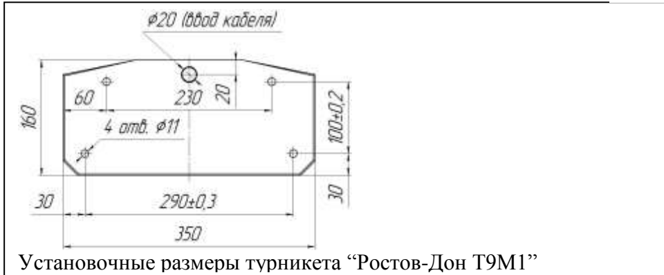
Габаритные размеры турникета "Ростов-Дон" Т9М1"
