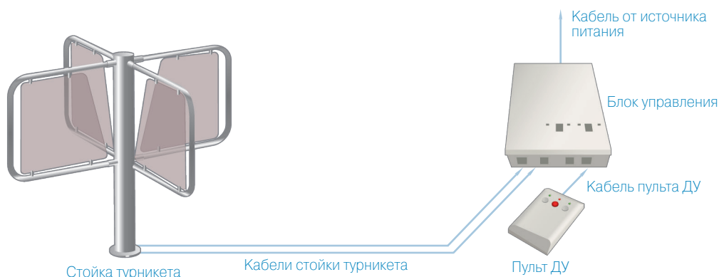
Схема подключения турникета PERCo-RTD-03S
